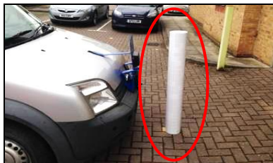
1 m lange paal voor een camera die op een hoogte van 0,6 m is bevestigd
